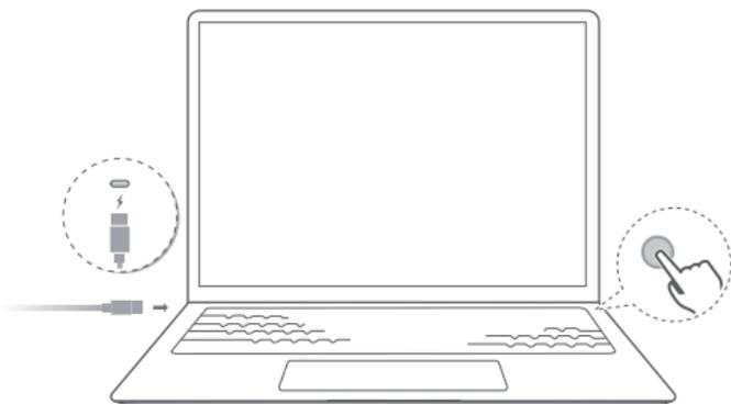
**首次开机时，必须先连接电源适配器，连接后，计算机会自动开机。**
